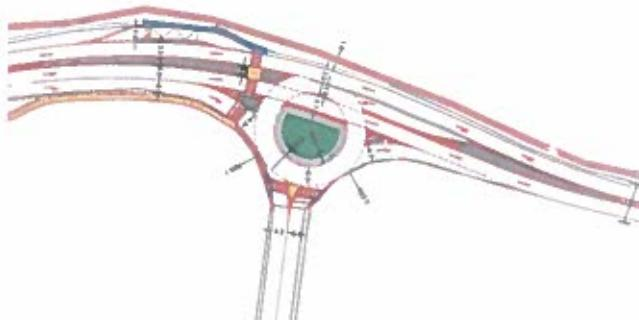
**Figura nr. 2.3.3.7 Exemplu de amenajare cu posibilități de întoarcere a unei intersecții în T**
